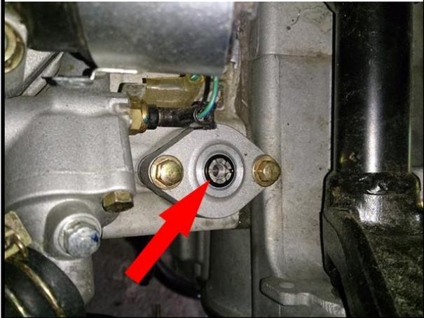
3. Déposer les deux **Vis de fixation (H8)** du Tendeur en les dévissant progressivement et alternativement l'une et l'autre.
