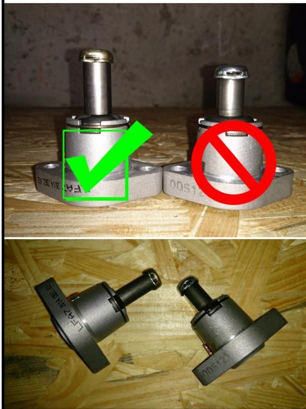
2. Rechercher une marque perpendiculaire à l'axe de déploiement du Poussoir de tendeur, sur le tronc du **Poussoir de tendeur usagé**. Si une telle marque est visible elle indique alors le niveau de détente qu'avait atteint le Poussoir de tendeur durant son utilisation sur le moteur.
