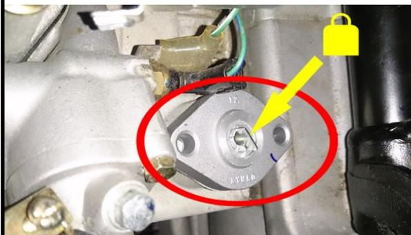
4. Poser les **Vis de fixation (H8)** du Tendeur de chaîne en les serrant à la main jusqu'à la butée, puis serrer définitivement au couple de **9 Nm**.
