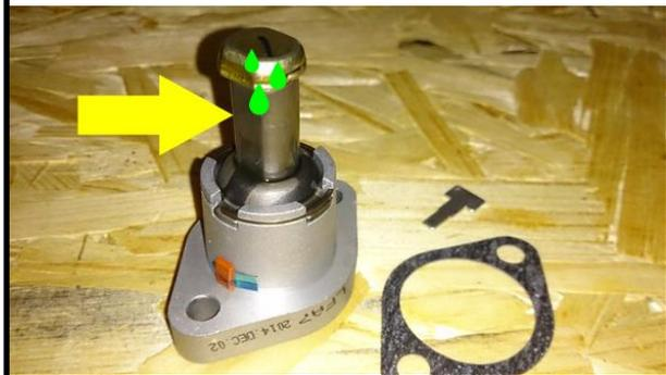
2. Insérer la **Clavette de rétractation** dans l'orifice de commande puis remonter le mécanisme du **Poussoir de tendeur** au maximum et verrouiller la position. Insérer un **Joint de tendeur** neuf.
