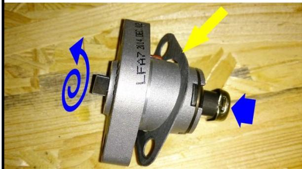
3. Présenter le **Tendeur de chaîne** dans son logement sur le moteur, avec son **Joint neuf**, tout en veillant à ce que la position rétractée du Poussoir de tendeur reste bien verrouillée grâce à la Clavette de rétractation.
