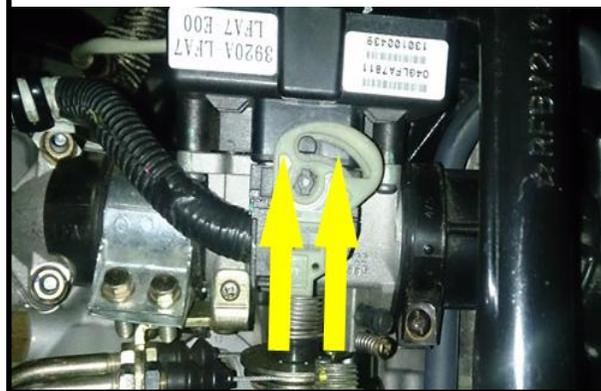
4. Engager la **Durite d'admission d'air** sur le **Boîtier ECU/Papillon** (ne pas serrer le Collier de serrage de la Durite).
