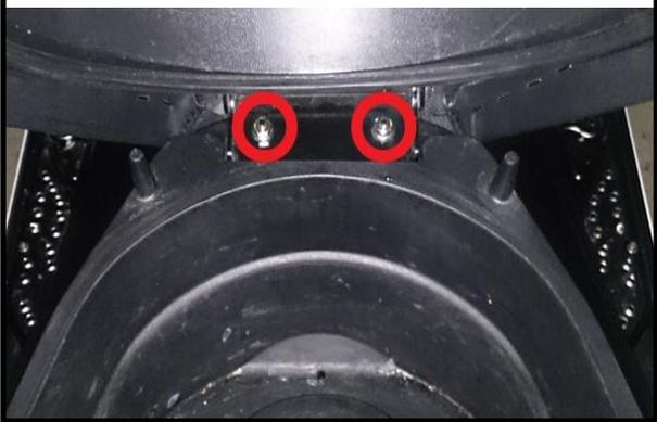
**13.** Raccorder le **Vérin de selle** à son attache sur la Selle (écrou H10 et vis H12).
