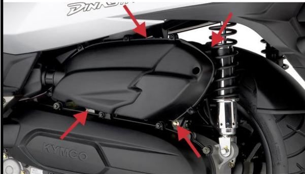
11. Desserrer la vis (PH2) du Collier de la durite d'admission d'air et dégager la Durite du Boîtier ECU/Papillon (il n'est pas nécessaire de déposer complètement la Boîte à air).
