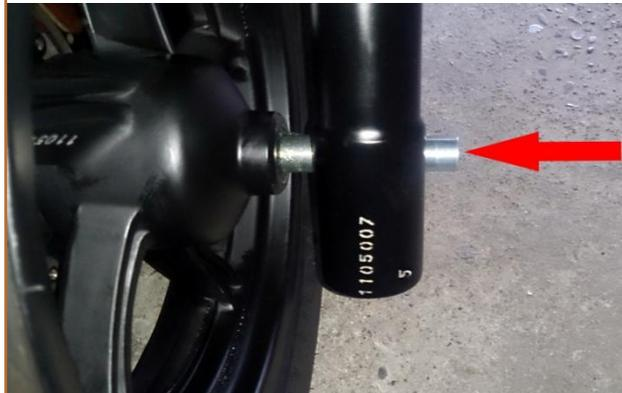
**c.16** Eliminer les excédants de graisse accumulés aux deux extrémités de l'**Axe de roue avant**.
