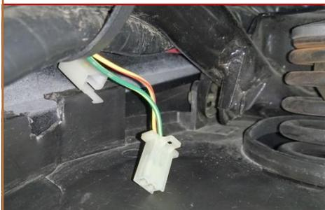
**a.5** Traiter le connecteur du **Régulateur**, situé derrière le faisceau entre le régulateur et le relais de démarreur.
