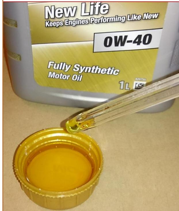
**b.10** Glisser le tube-pipette d'huile moteur dans la **Chambre de combustion** du moteur, par l'**Orifice de la bougie d'allumage**, tout en maintenant l'extrémité du tube bouchée. Ôter le doigt de l'extrémité afin de laisser l'équivalent des 3 gouttes d'huile (*pas plus*) s'écouler dans la chambre de combustion. Essuyer les éventuelles coulures d'huile.
