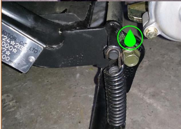
c.2 Lubrifier l'articulation de la **Béquille latérale** avec de la graisse de synthèse.
