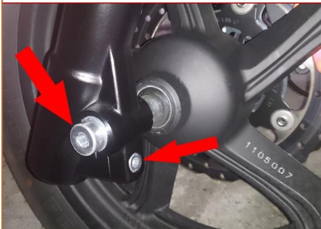
**c.7** Soulever l'avant du scooter et déposer la **Roue avant** (laissez le scooter reposer sur la cale).
