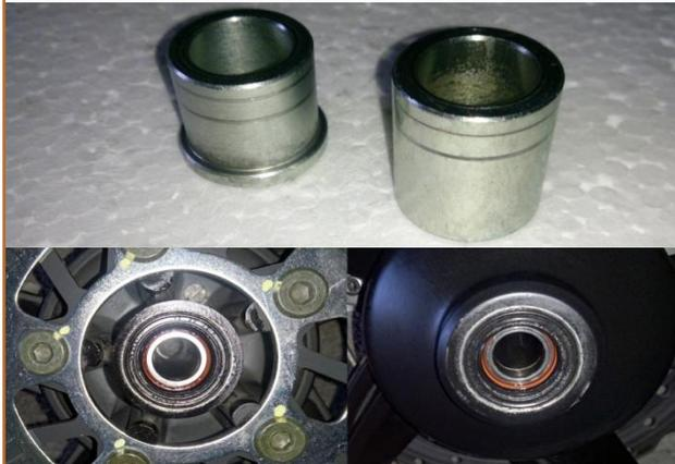
**c.10** Graisser les **Logements des entretoises**, sur la roue, avec de la graisse de synthèse.
