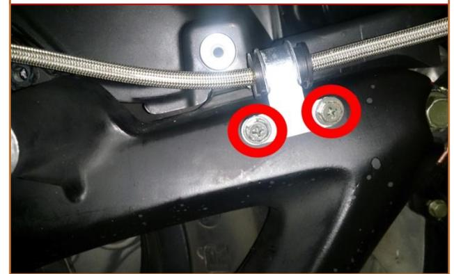
**c.48** Remonter le **Bras arrière** sur le scooter en veillant à l'introduction de l'axe et à l'entretoise. Fixer le **Bras arrière** sur le bloc moteur (2 vis H14 à serrer au couple de 45 Nm).
