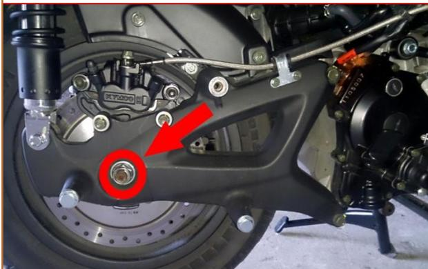
**c.33** Déposer l'**Etrier de frein arrière** du bras arrière (2 vis H12) et le dégager au dessus du garde-boue arrière.
