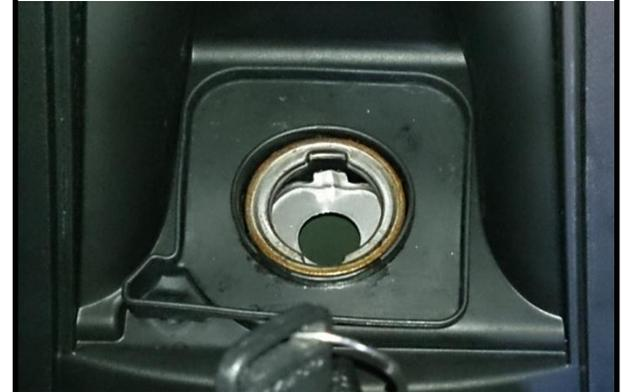
Le plein d'essence devra être fait à fond et presque à ras bord du réservoir de manière à ne pas laisser de place à la condensation de l'humidité contre les parois internes du réservoir, qui pourrait alors amorcer une oxydation interne de la tôle.
