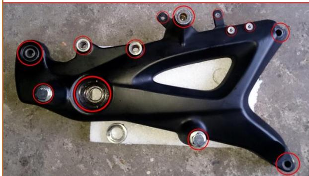
**c.39** Retirer la **Douille de roulement** de roue arrière, située sur l'axe de la roue arrière
