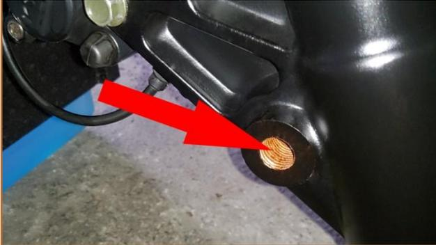
**c.14** Nettoyer l'**Axe de roue avant** à l'aide d'une microfibre et de produit dégrippant et anticorrosion (type WD40).
