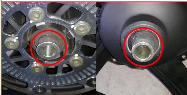
**c.9** Avec une microfibre et du produit dégrippant/anticorrosion (type WD40), nettoyer les **Entretoises** et leurs **Logements** sur la roue.
