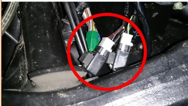
**b.9** Traiter les connecteurs et les bornes des **Relais de pompe et d'ECU**, laisser sécher le produit et remonter les relais sur leurs supports.
