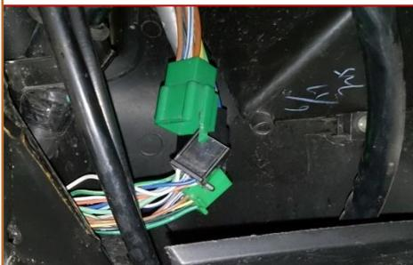
**b.5** Déposer le **Relai des clignotants** de son support (*1 écrou H10*). Traiter le connecteur et les bornes du relai, laisser sécher le produit, rebrancher le relai et le remonter sur son support (*1 écrou H10*).
