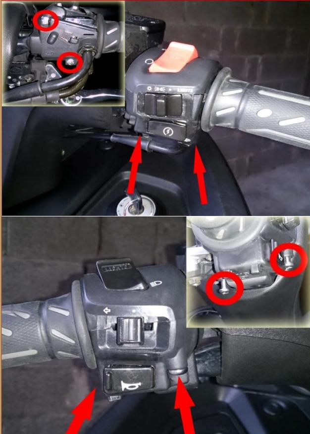
c.2 Nettoyer l'intérieur du **Boîtier de commutateurs gauche** avec du nettoyant spécial contacts électriques et graisser les mécanismes de contact avec de la graisse de synthèse.
