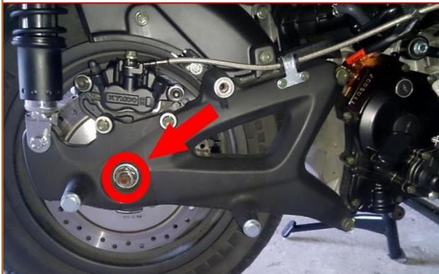
**c.58** Nettoyer soigneusement le **Bras arrière** avec un chiffon microfibre et du produit dégrippant/anticorrosion (type WD40).
