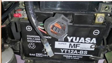
**a.3** Traiter le connecteur de la **Commande de démarreur**, situé le long du faisceau électrique, sous le relais de démarreur.
