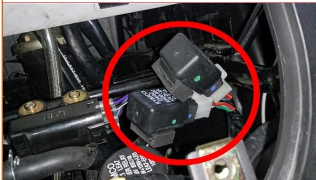
**b.11** Rebrancher les connecteurs du **Combiné d'instruments**.
