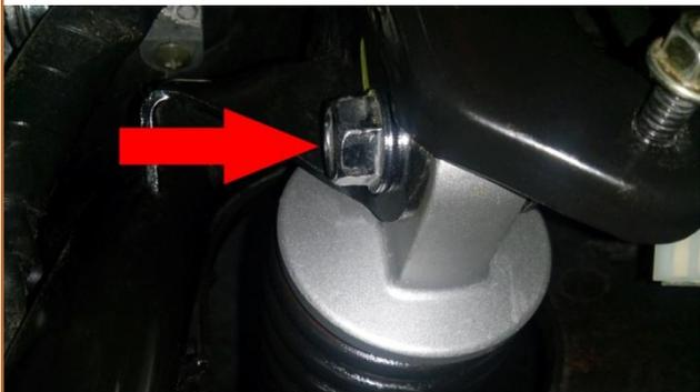
**c.56** Remonter l'écrou (H24) de l'**Axe de roue arrière** et le serrer au couple de **120 Nm**.
