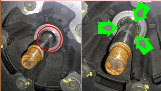
**c.43** Graisser la paroi intérieure de la **Douille de roulement** de la roue arrière avec de la graisse de synthèse puis la remonter sur l'axe de roue.
