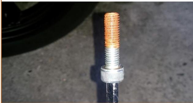
**c.19** Serrer la **Vis de blocage (HX 6)** de la fourche sur l'axe de roue avant.
