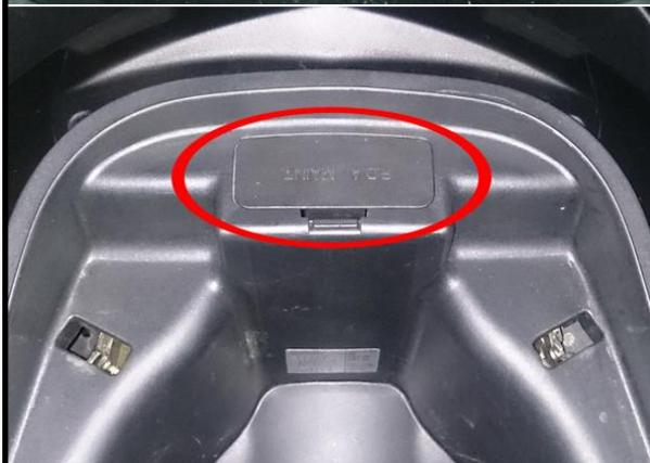
9. Poser et serrer les **Fixations du coffre à casques** (2 écrous et 2 vis H10 et un rivet plastique coté droit du passage de roue arrière).
