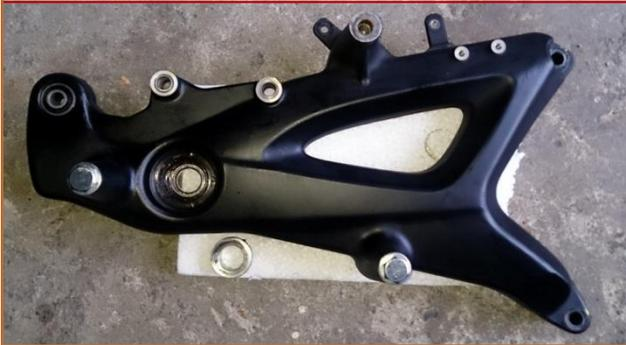
**c.36** Nettoyer les **Surfaces d'appui** des fixations du bras arrière, face intérieure, à l'aide d'une microfibre et d'un produit dégrippant et anticorrosion (type WD40).
