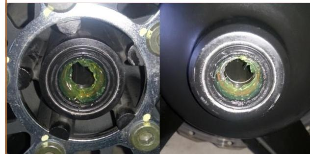
**c.11** Graisser aussi les parois intérieures des **Entretoises** droite et gauche et les replacer dans leurs **Logements** sur la roue :
