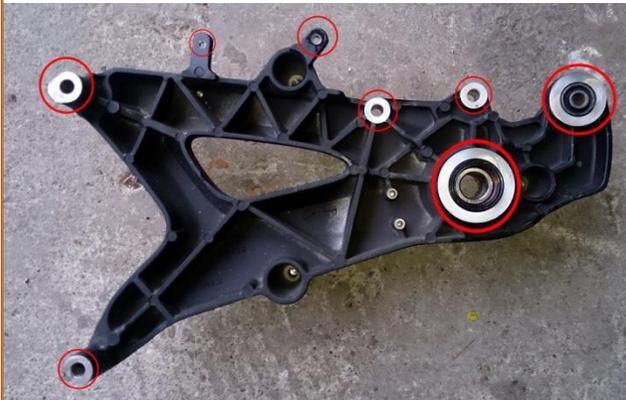
**c.37** Retirer l'**Entretoise de roulement** de roue arrière sur le bras arrière, face extérieure, en la faisant glisser avec le doigt.
