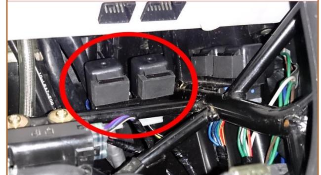
**b.7** Faire descendre les deux **Relais de feux** et leurs faisceaux vers le passage de la roue avant (*cela permet un meilleur accès à leur connecteurs*).
