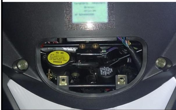
2. Remonter la Trappe d'accès au remplissage du radiateur (2 vis PH2).
