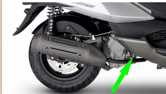
**c.26** Déposer la **Ligne d'échappement** complète (3 vis H14).
