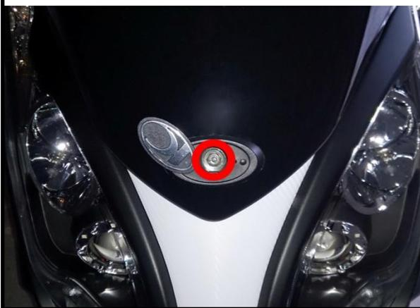
14. Déposer la **Trappe d'accès** de remplissage du radiateur, derrière le pare-brise (2 vis PH2).
