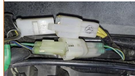
**a.2** Traiter le connecteur du **Capteur d'ouverture du coffre**, attaché à la platine du verrou droit de la selle.
