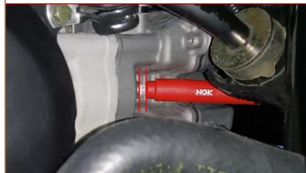
**b.14** Reposer les deux **Vis de visu du stator** (utiliser une pièce de monnaie pour les serrer à la seule force de la main).
