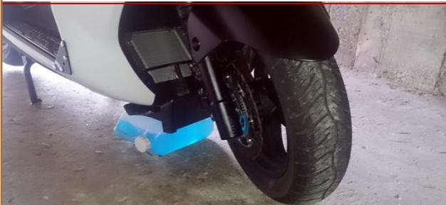
**c.15** Insérer l'**Axe de roue avant** dans la roue avant et le serrer (*vis HX8*) au couple de **20 Nm**.
