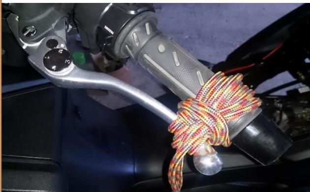
**c.32** Débloquer la **Poignée de frein arrière** et donner quelques coups de frein arrière afin de rétablir le jeu entre les plaquettes et le disque.
