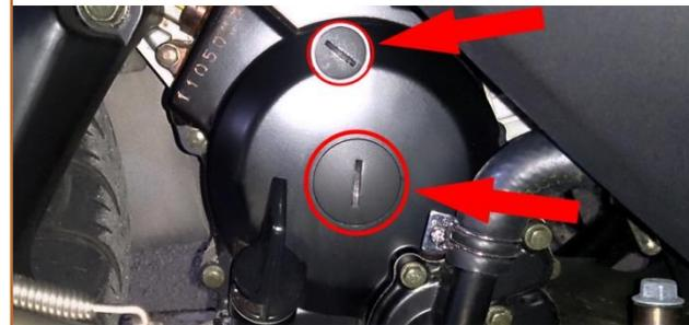
**b.7** Tourner le **Volant magnétique du stator** (*écrou H19*) dans le sens horaire pour positionner le moteur au Point Mort Haut (PMH).
