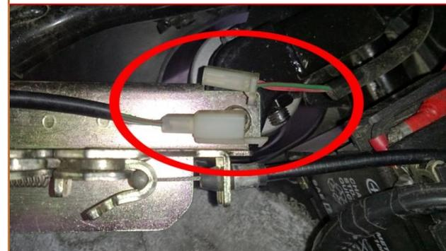
**c.22** Déposer la **Platine du verrou droit** de la selle (2 écrous H10) et la dégager vers le garde-boue de la roue arrière.
