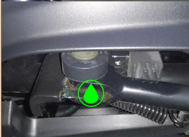
c.3 Placer le scooter sur sa Béquille latérale et faire effectuer plusieurs va-et-vient à la **Béquille centrale** sur ses articulations.
