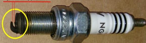
**b.4** Enduire la **Borne** de la bougie avec un peu de graisse au cuivre. Essuyer l'excédant sur l'isolant.
