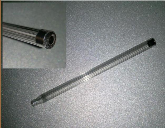
**b.9** Récupérer l'équivalent de 3 gouttes d'huile moteur dans le tube-pipette de précision (utiliser l'huile habituelle du moteur).
