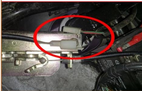
**a.4** Traiter le connecteur de la **Sonde Lambda** (*situé sous la bobine HT de l'allumage*) et le connecteur de l'**Eclairage de coffre**.
