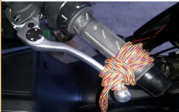
**c.57** Débloquer la **Poignée de frein arrière** et donner quelques coups de frein arrière afin de rétablir le jeu entre les plaquettes et le disque.
