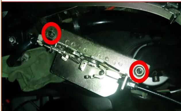
**c.61** Présenter la **Ligne d'échappement** en position sur le scooter et introduire la **Vis supérieure** de fixation sur le bras sans la serrer.
