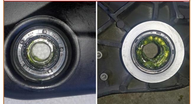
**c.42** Graisser la **Tige** de l'axe de roue arrière avec de la graisse de synthèse et le **Pas de vis** de l'axe de roue arrière avec de la graisse au cuivre.
