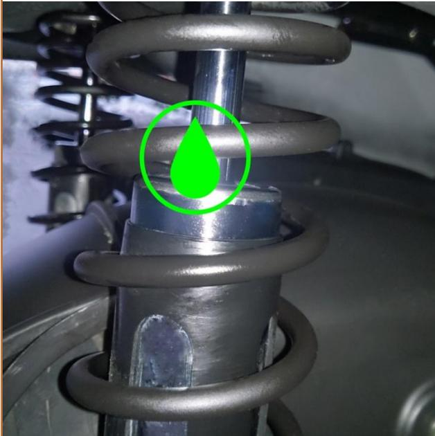
**a.6** A l'aide d'un chiffon microfibre, appliquer du produit dégrippant/anticorrosion (type *WD40*) sur les **Tubes plongeurs** et les **Jointspy** de la fourche.
