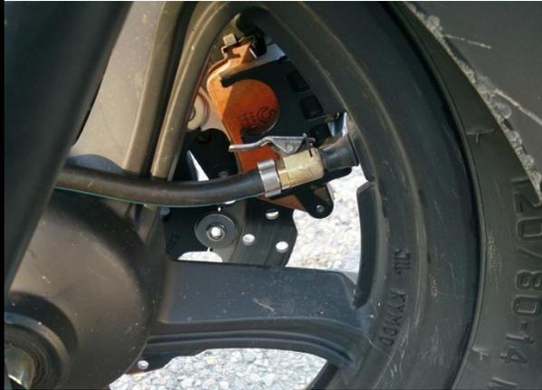
La pression des pneus doit être faite le plus tôt possible après le départ. Les pneus ne doivent pas être chauds sinon l'air qu'ils contiennent sera moins dense et la pression réelle à température ambiante sera faussée.
