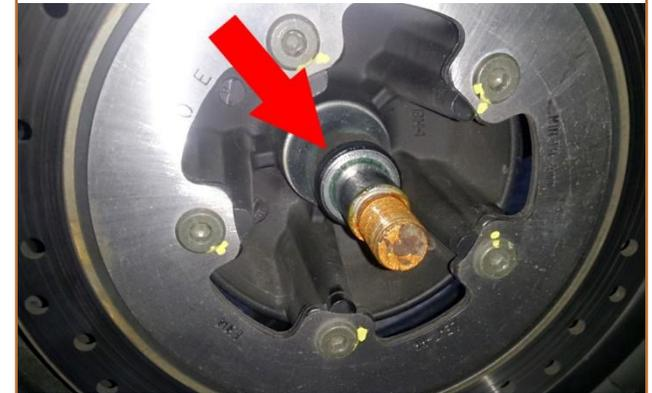
**c.40** Nettoyer l'**Entretoise de roulement** et la **Douille de roulement** de roue arrière avec une microfibre et du produit dégrippant et anticorrosion (type WD40).
