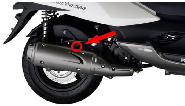
**c.63** Fixer la **Ligne d'échappement** sur le bras arrière en serrant les 3 vis de fixation (H14) au couple de **35 Nm**.
